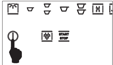
Fig. 7.10 Pour quitter la modalité Stand-by, enfoncer la touche on/off d'après la fig. 8.10, le voyant commence à clignoter jusqu'à ce que la machine soit en état de « prête » ; à présent, tous les voyants, relatifs aux différents services, s'allument.
